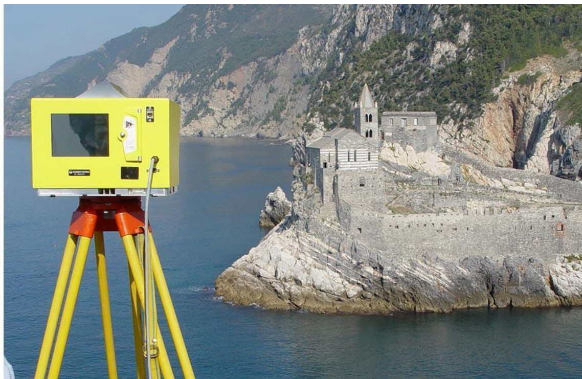
(Figure 1 – Chiesa di San Pietro durante il rilievo laser ILRIS 3D)
