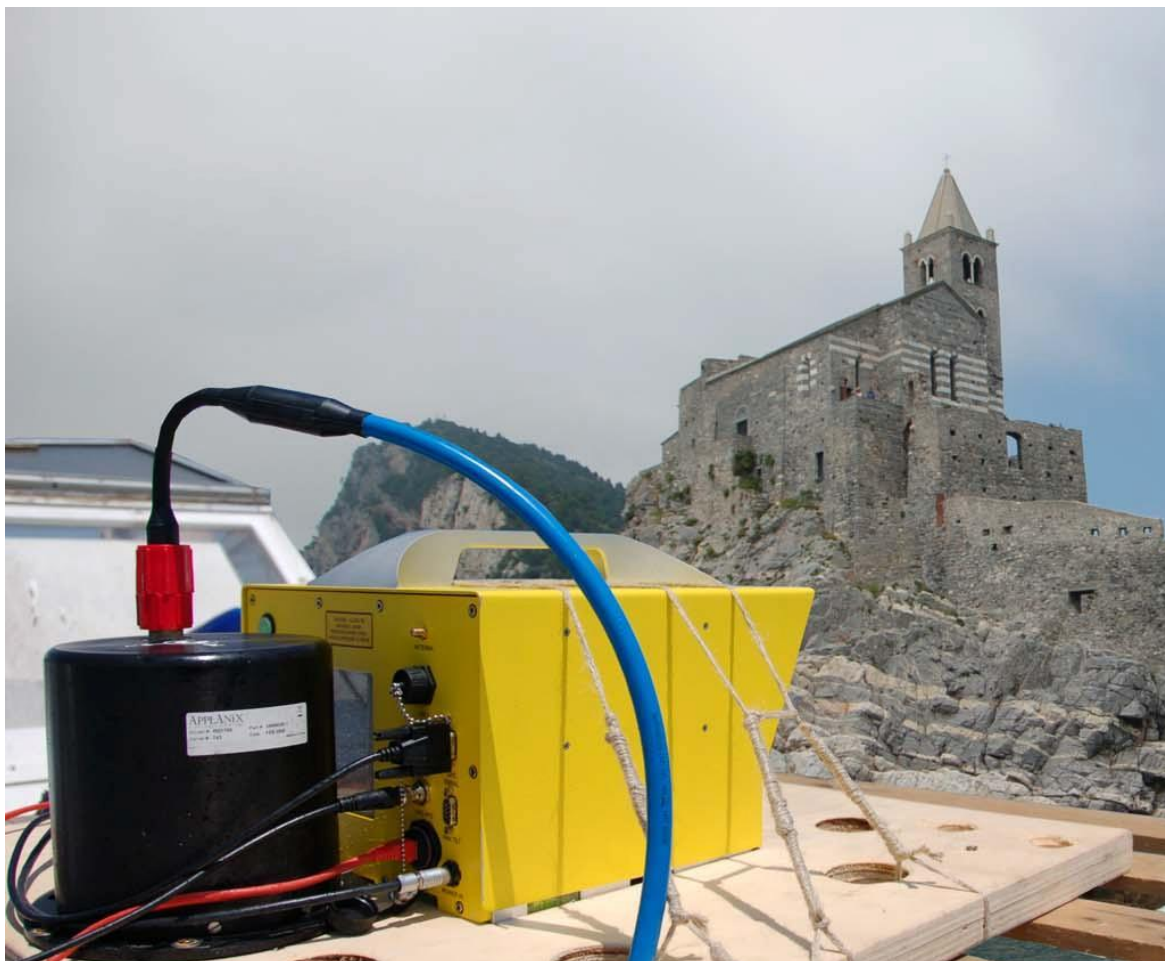
(Figure 5 – Rilievo laser dinamico della baia )
